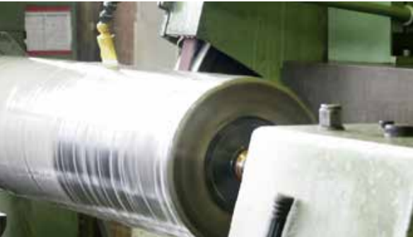
Broušení pístnic a válců nakulato, např. mezi hroty
