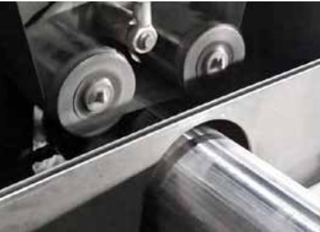
Broušení podélných švů svařovaných trubek
