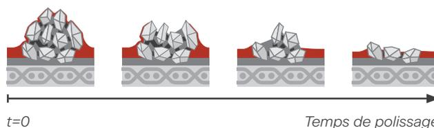
La gamme **VSM COMPACTGRAIN** est fabriquée entièrement avec des granulés contenant de nombreux grains abrasifs. Les grains usés se détachent sous l'action des forces de coupe et laissent place aux grappes de grains sous-jacentes.
