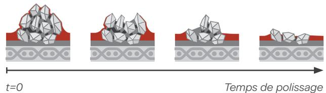
La gamme **VSM COMPACTGRAIN** est fabriquée entièrement avec des granulés contenant de nombreux grains abrasifs. Les grains usés se détachent sous l'action des forces de coupe et laissent place aux grappes de grains sous-jacentes.
