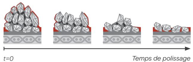
Avec sa grande réserve de grains et une adhérence du granulat optimisée, la série **VSM COMPACTGRAIN Plus** présente une usure uniforme. Le granulat présent sur le support est utilisé dans son intégralité.
