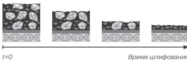
Специально разработанная технология производства **VSM ILUMERON** реализует равномерное распределение абразивных зерен в связке и их постепенное, предсказуемое стачивание по всей площади.
