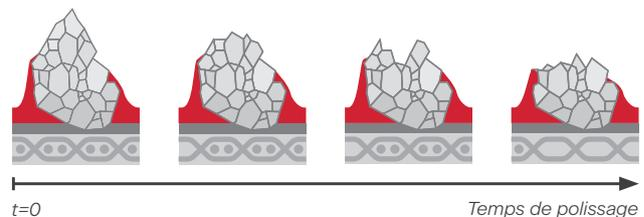
La structure cristalline très fine des grains abrasifs **VSM CERAMICS**, permet d'obtenir, lors de l'usure du grain, une structure bien plus fine et plus coupante.
