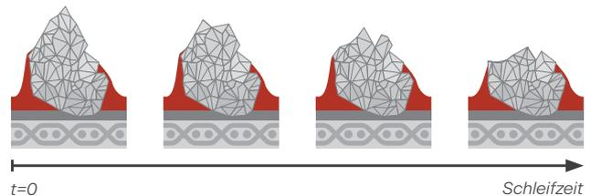
Aufgrund der optimierten und so feineren, mikrokristallinen Kornstruktur der **VSM CERAMICS Plus** Serien baut sich das Keramikkorn beim Schleifprozess definiert ab und erzeugt dadurch immer wieder neue, scharfe Schneidkanten.
