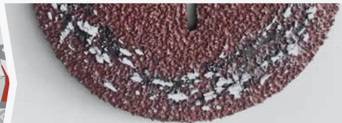
Mit Aluminiumspänen zugesetzte Fiberscheibe
