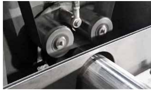
Polissage des cordons des tubes soudés
