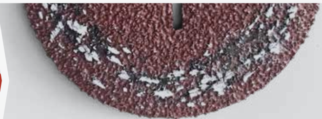
Fiberrondell igensatt med aluminiumspån
