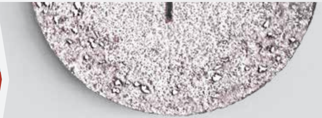
VSM ALU-X: Det är tydligt att färre spån fastnar.
