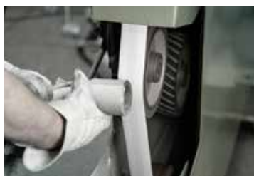
Slipning av gjutdelar
